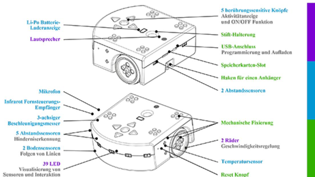
Das Medienzentrum hat zwei Koffer mit je fünf kleinen Thymio II-Robotern angeschafft: Diese mit vielen Sensoren ausgestatteten Roboter lassen sich auf einfachste Art und Weise ansprechen, denn die Roboter sind von einem PC aus über Funk zu programmieren. In der Grundstufe kann man allerdings auf die Programmierung komplett verzichten und Grundfunktionen direkt mit dem Gerät erarbeiten.
