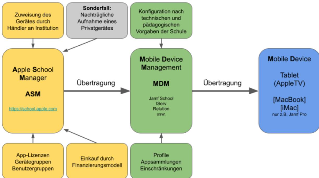
Um ein Gerät steuern zu können, muss ein iPad in den sogenannten School-Manager einer Schule integriert sein. Am einfachsten ist diese Integration, wenn sie bereits vor dem Kauf durch einen zertifizierten Händler vorgenommen wird. Das Verfahren ist z.B. bei alternativen Hersteller:innen vergleichbar - bei Chromebooks (Google) läuft es z.B. analog. Das Gerät ist damit „supervised“, d.h. Nutzer:innen können Voreinstellungen der Schule nicht einfach wieder rückgängig machen.
